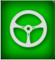
Eingekuppelt (grün): Sie verwenden die automatische Lenkung und fahren auf einem Muster oder einer Linie.
